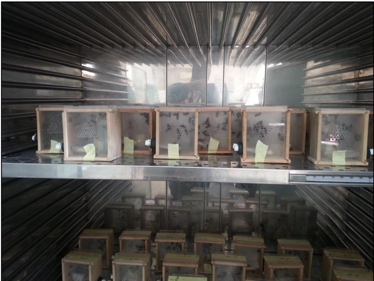
Figure 1 - Cagettes de contention de type Pain en place dans une étuve lors d'un essai toxicologique (Photographie CHAHBAR-2016).
